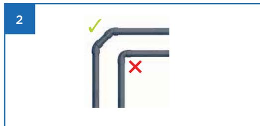
Se si desidera installare curve a gomito nella condotta di scarico, utilizzare 2 curve a 45° anziché un'unica curva a 90°.
