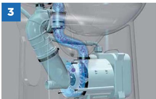
Il materiale triturato finemente viene espulso. Una valvola clapet impedisce che l'acqua di scarico torni indietro.
