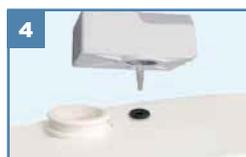
Fissare il dispositivo Sanialarm all'apertura del tubo.
