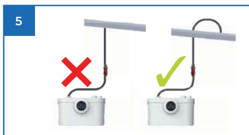
La condotta di evacuazione della stazione di sollevamento deve **essere innestata nella colonna di scarico dalla parte superiore, seguendo il verso dello scarico.**
