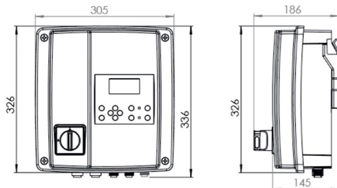
Das SMART-Terminal ist eine Lösung zur Steuerung und Überwachung der Anlage und zeichnet sich durch eine einfache Installation aus. Über das Klartext-Display können verschiedene Parameter eingestellt sowie Meldungen zum Betriebsmodul der Pumpe angezeigt werden.
