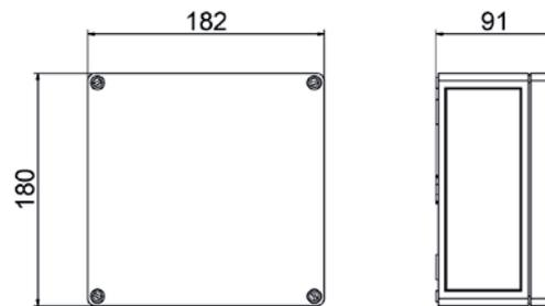
Die Steuerungen ZPS sind für die Wandmontage geeignet. Sie sind in 8 Ausführungen erhältlich.
