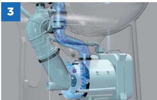
Das fein zerkleinerte Material wird ausgestoßen. Ein Rückschlagventil verhindert, dass Abwasser zurückfließt.
