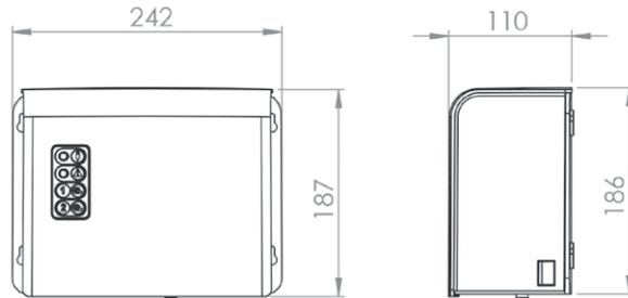
Die externe Steuerung ermöglicht das manuelle Einschalten der Pumpen und dient zur Anzeige von optischen und akustischen Alarmmeldungen. Im Lieferumfang sind vier Meter Kabel zur Verbindung mit der Pumpe.
