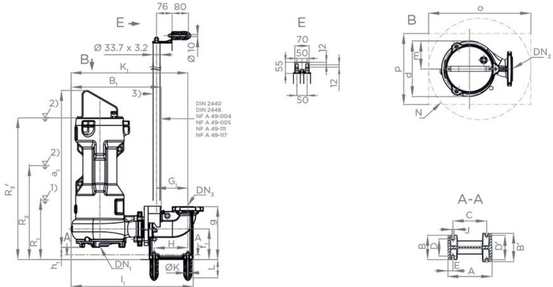
(1) Tiefster Ausschaltpunkt bei Automatikbetrieb (2) Mindestüberdeckung bei Dauerbetrieb (3) Nicht im Lieferumfang
